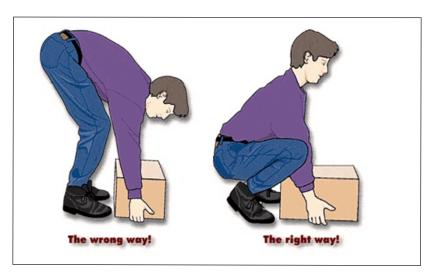
Fig. 5.1.5. Lifting loads echnique
